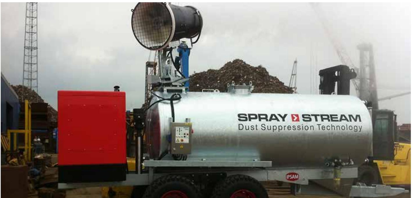
**SPRAYSTREAM 50 i bis 100 i AUTARKER ANHÄNGER MIT WASSERTANK UND GENERATOR**
