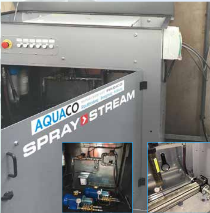
VERSORGUNGSEINHEIT ▪ Installationsbeispiel Pumpe und Steuerung für Staubbindemaschine
